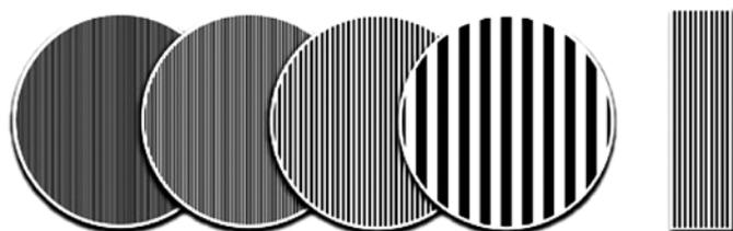
Figure 1. Lea Grating Acuity Test<sup>®</sup> Model 251300<sup>(13)</sup>.
